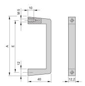
La poignée peut être montée sur un bac à cartes ou une face avant 19". Disponible avec une surface anodisée incolore ou noire. Les poignées seront boulonnées de l'arrière.
