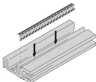
Le joint en acier inoxydable est fixé dans la rainure du profilé horizontal et permet le contact au capot supérieur.
