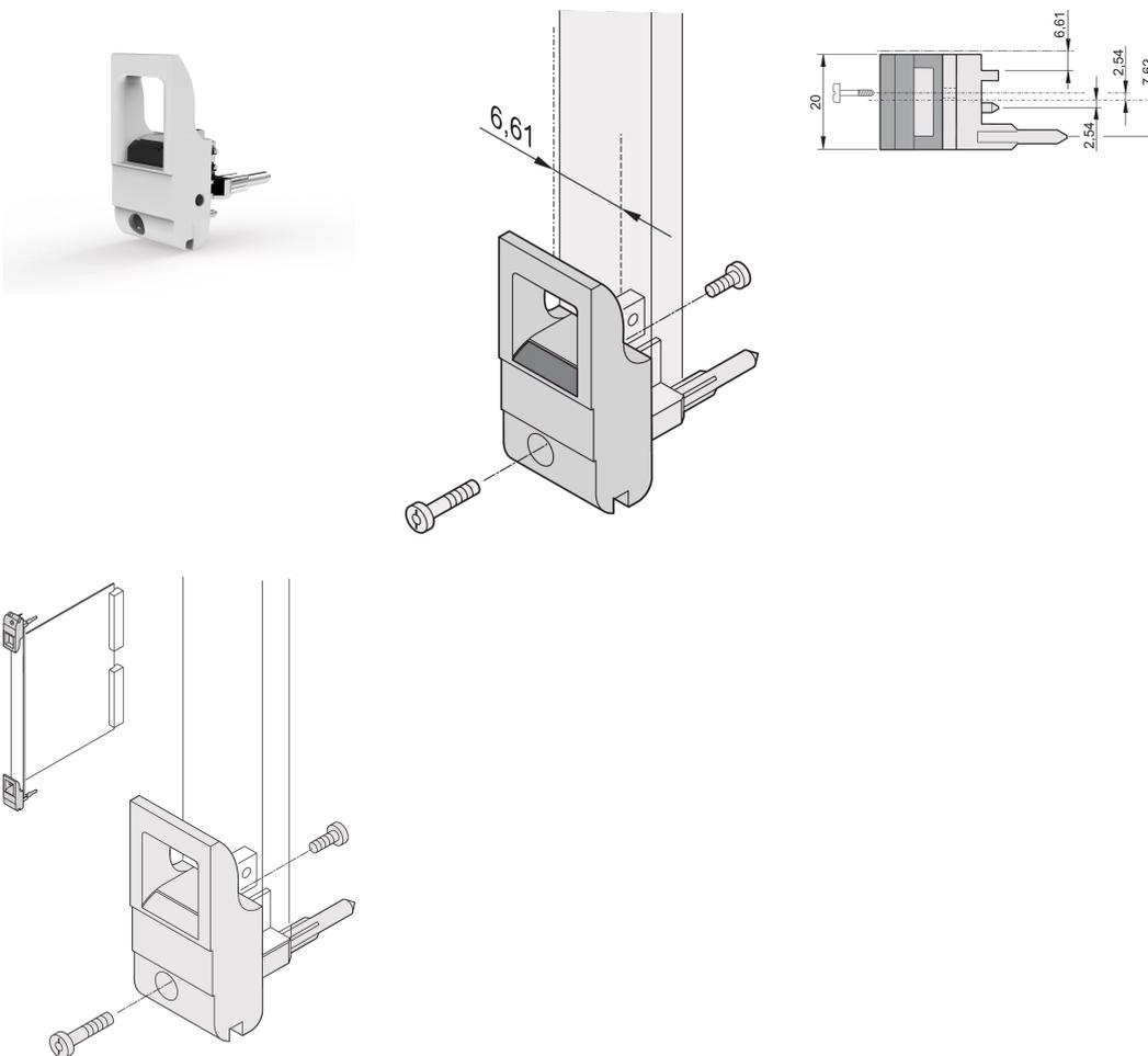
Poignée d'insertion/d'extraction, de type IET, conforme à l'IEEE 1101.10. Décalage 0,1". Pour une force d'insertion/extraction jusqu'à 700 N (par paire).
