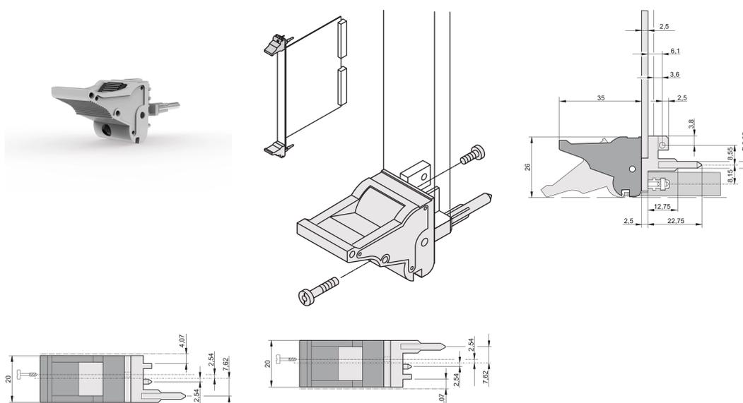
Poignée d'insertion/extraction, de type IEL, conforme IEEE 1101.10, avec décalage 0,1". Deux poignées peuvent supporter une force de 700 N (par paire).
