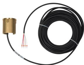
Sonde de sol pour la mesure combinée des valeurs de température et d'humidité dans les zones extérieures fréquentées par des piétons ou des véhicules. Version robuste en laiton, entièrement encapsulée. Très faible hauteur d'installation, donc particulièrement bien adapté aux escaliers, terrasses, etc.
