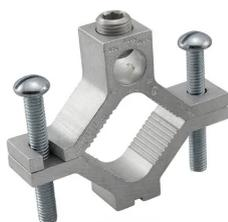
L'étrier de mise à la terre pour tuyau d'eau et de gaz nVent ERICO PermaGround est fabriqué en alliage d'aluminium 6061-T6 haute résistance et est utilisé pour connecter des conducteurs en cuivre ou en aluminium à un tuyau d'eau en cuivre, à un tuyau galvanisé ou à un conduit en acier. Grâce à sa capacité à couvrir un large éventail de conducteurs et de tuyaux, ce connecteur est idéal pour les installations nécessitant de grandes longueurs de fil de terre.
