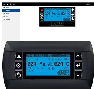
L'unité d'affichage permet la configuration locale, la mise en service et la surveillance du RackChiller Rear Door. Elle comprend un écran d'affichage LCD et 6 touches de fonction. Elle s'installe directement sur la face externe du refroidisseur et se connecte grâce au précâblage prévu dans l'unité.
