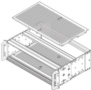
Un capot est utilisé pour le blindage électromagnétique ou comme protection mécanique.
