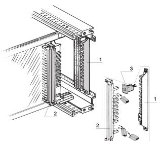
Le détrompage s'effectue au niveau d'un connecteur. Avec le détrompage, seule la carte avec le codage complémentaire peut être insérée au bon slot.
