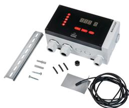
nVent RAYCHEM RAYSTAT V5 est un régulateur électronique de détection de ligne ou de régulation proportionnelle par détection de la température ambiante (PASC) pour câbles chauffants autorégulants. Montable au mur à l'extérieur, il mesure la température ambiante et détermine le temps de cycle pendant lequel les câbles chauffants seront alimentés, ce qui permet de réaliser des économies d'énergie très importantes.
