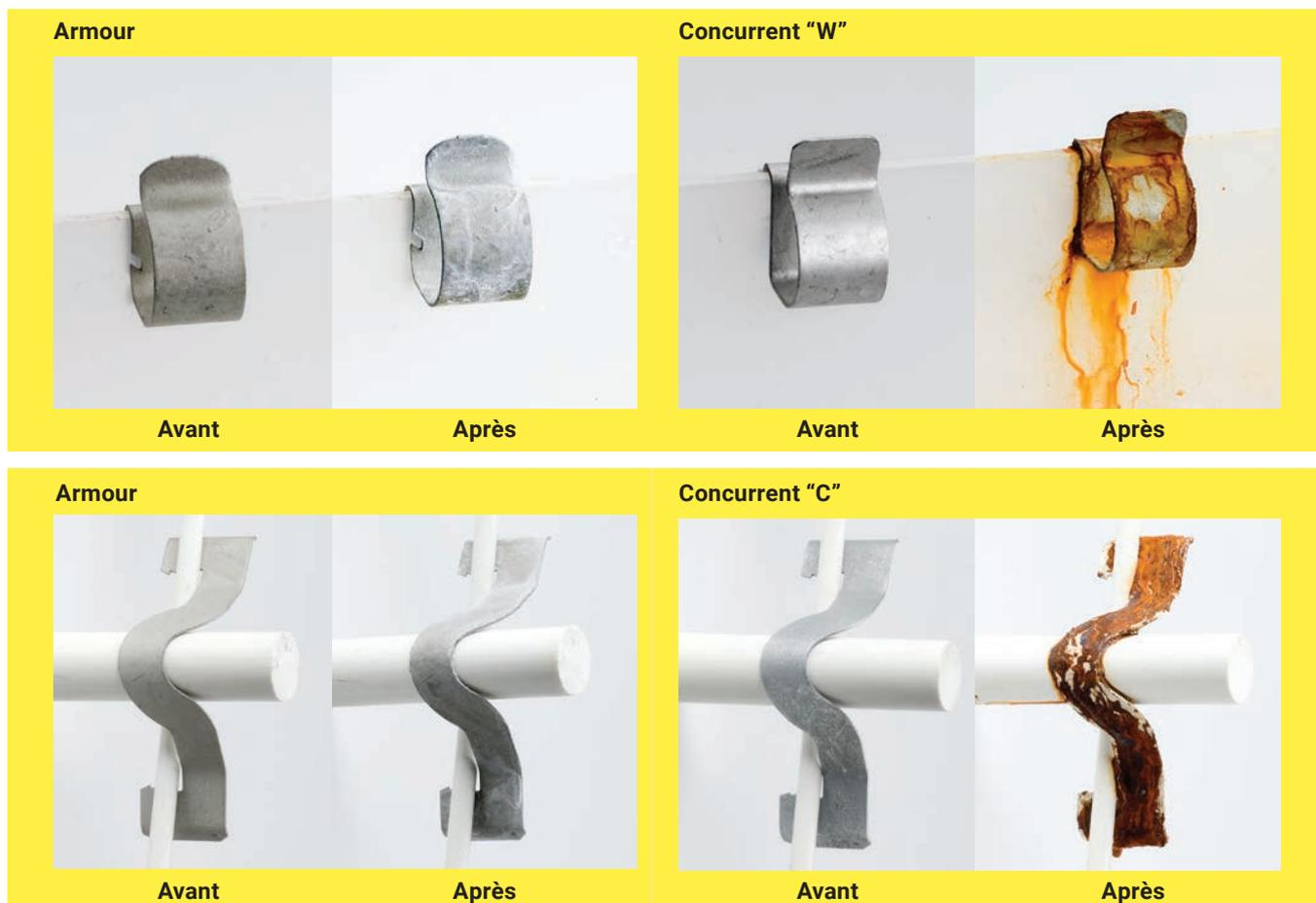
\* Méthode d'essai au brouillard salin : ASTM B117 / DIN 50021. Méthode d'essai de corrosion cyclique : GM 9540P. Voir <https://www.nVent.com/our-brands/CADDY> pour les conditions de la garantie Armour valable dix ans.
