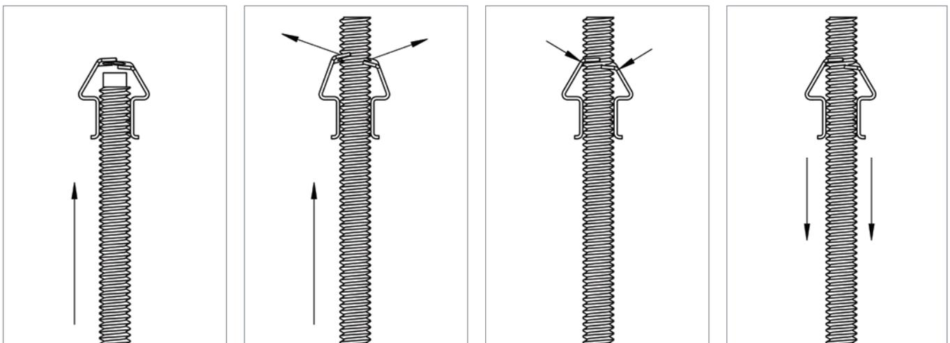
1 La tige filetée rentre dans l'attache et pousse les deux lames flexibles
