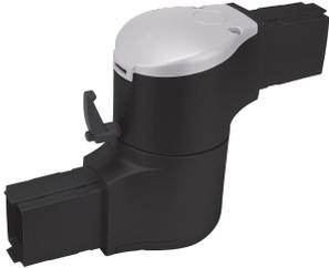
Le joint intermédiaire Syspend 180-Max unit deux tubes horizontaux pour une plus grande longueur. Le bras peut pivoter à 300 degrés. Comprend un arrêt de sécurité et un palier sans entretien. L'utilisation du joint intermédiaire réduit la capacité de charge de base du système à 66 kg (146 lb) de 1 m (3,3 pi).
