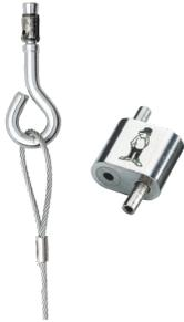
Le nVent CADDY Speed Link Light Pack avec goujon d'ancrage comprend une longueur prédécoupée (1m et 2m) de câble en acier de 1mm riveté à un goujon d'ancrage, ainsi qu'un dispositif de verrouillage ultra-discret. Les installateurs peuvent le fixer rapidement et en toute sécurité aux plafonds en béton afin de suspendre et sécuriser les luminaires et la signalétique.
