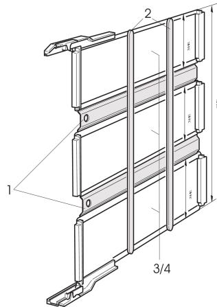
Kit de support pour réaliser un adaptateur de test 6/9 U à partir des adaptateurs de test 3 U. Convient pour les adaptateurs de test avec connecteurs DIN 41612 de type B, C, E et F.
