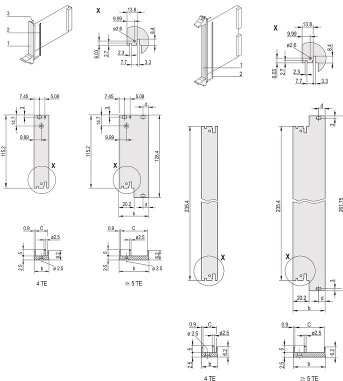
La face avant en U peut être blindée avec un joint textile. Elle peut être combinée avec la poignée trapézoïdale IEL et IET ou de type 2, fixation de carte avec décalage 0,1".
