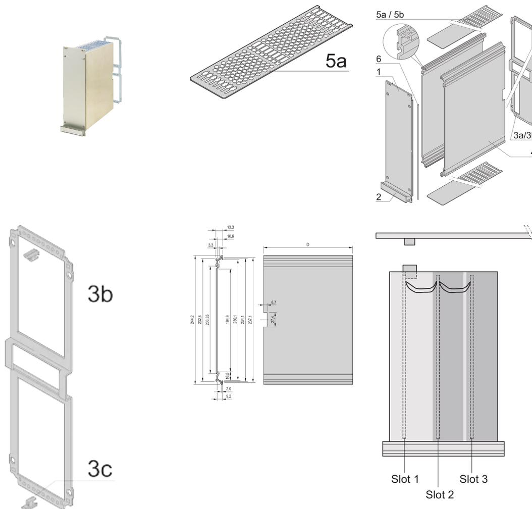
Protège un circuit imprimé contre les dommages mécaniques et décharge les accumulations électrostatiques.
