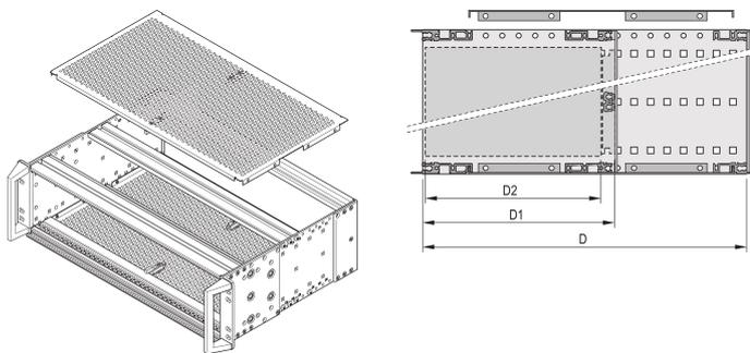
Un capot est utilisé pour le blindage électromagnétique ou comme protection mécanique.
