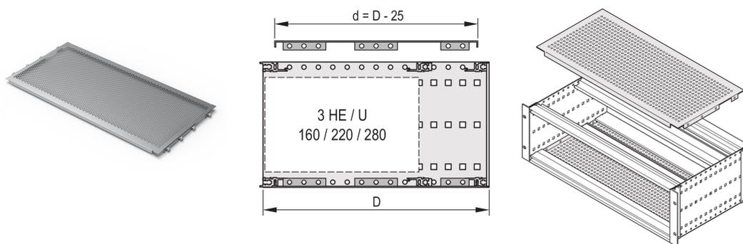
Les capots sont utilisés pour le blindage électromagnétique et/ ou comme protection mécanique. Les capot peuvent être vissés sur les flancs.
