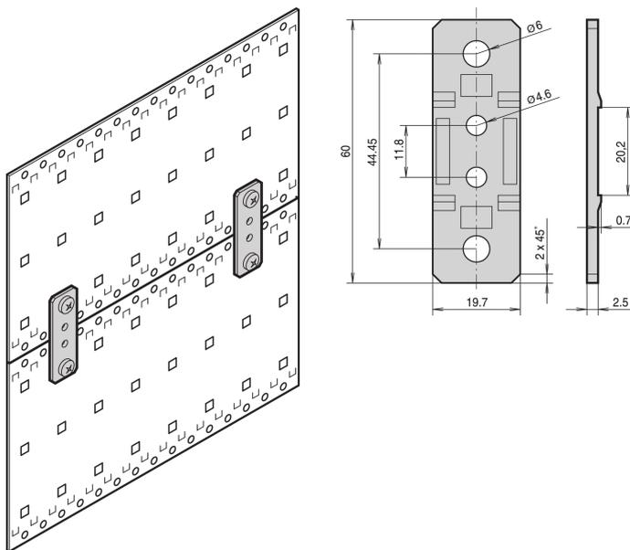
Les supports sont utilisés pour relier les modules de ventilation aux faces latérales d'un bac à cartes.
