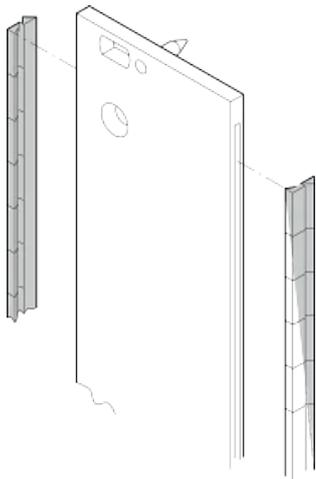
Les joints CEM en acier inoxydable sont insérés dans les rainures latérales des faces avant blindées (2 pièces par face avant).
