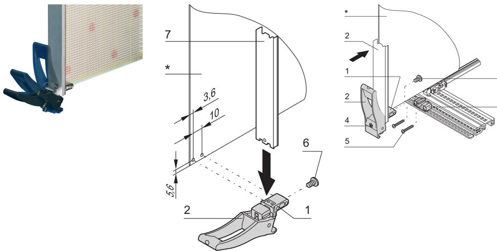
Adapté pour les forces d'insertion et d'extraction jusqu'à 1500 N (par paire). Fixation solide de la carte à l'aide de 2 vis. La fonction d'insertion sera soutenue par une pièce de détrompage qui sera montée sur le profil horizontal.
