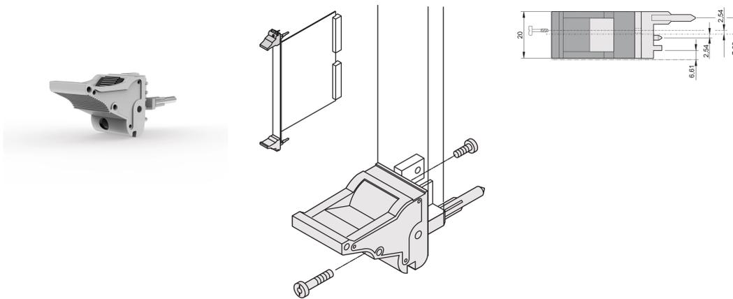
Poignée d'insertion/extraction, de type IEL, conforme IEEE 1101.10, avec décalage 0,1". Deux poignées peuvent supporter une force de 700N (par paire).
