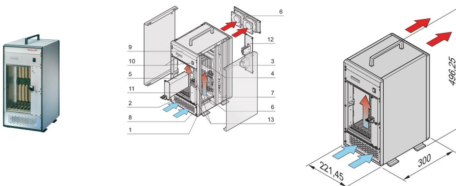
Système VME64 version tour pour 7 cartes VME64x 6U, 160 mm. L'alimentation du système est créée par une alimentation électrique enfichable. Un module de régulation du ventilateur surveille les ventilateurs, la température et la tension.
