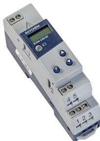
Le thermostat de régulation en surface numérique compact nVent RAYCHEM TCON-CSD/20 a été conçu pour la régulation de la température (MARCHE/ARRÊT), dans les zones non explosibles. La température est mesurée par une sonde et est indiquée sur un afficheur à cristaux liquides. L'état du relais de sortie est signalé via un voyant DEL.
