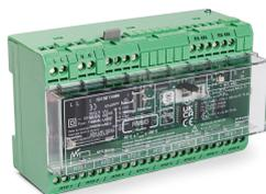
nVent RAYCHEM RMM3 est un module de surveillance à distance des températures pour les régulateurs NGC et les systèmes de surveillance. Il peut connecter un maximum de huit sondes (RTD) qui mesurent la température des tuyauteries, des cuves, ou la température ambiante. Plusieurs unités communiquent avec un seul contrôleur afin d'assurer la surveillance des températures de manière centralisée.
