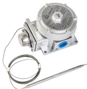
Le modèle nVent RAYCHEM Raystat-EX-02 est un thermostat de régulation de surface mécanique pour zone explosible offrant une régulation de la température pour les câbles chauffants. Plage de températures de commutation comprise entre -4 °C et 163 °C, le réglage s'effectue au moyen d'un cadran situé à l'extérieur du boîtier Ex, monté sous un couvercle boulonné avec joint d'étanchéité. Le courant de coupure s'élève à 22 A.
