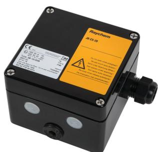
Les modèles nVent RAYCHEM JB-EX-XX sont des boîtes d'accouplement avec ou sans plaque de mise à la terre et goujon de terre externe. Selon le type, ils sont équipés de bornes de 10 mm<sup>2</sup> ou 35 mm<sup>2</sup> pour permettre des charges allant jusqu'à 100 A à une alimentation électrique ou d'autres configurations telles que les T ou les jonctions. Disponibles en différentes tailles avec plusieurs entrées M20 pour accueillir plusieurs configurations et charges électriques.
