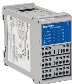
Le module d'E/S nVent RAYCHEM NGC-40 fournit jusqu'à quatre entrées RTD supplémentaires. Il peut être associé à n'importe quel module NGC-40-HTC/HTC3. Il fournit également un relais avertisseur qui peut être connecté à un indicateur externe et une entrée numérique programmable, et peut être associé à un module NGC-40-HTC/HTC3 pour diverses fonctions, telles que forcer l'activation ou la désactivation du contacteur ou du relais statique (SSR).
