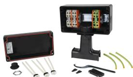
nVent RAYCHEM JBM-100 est une boîte de jonction modulaire utilisée pour connecter l'alimentation à un maximum de trois câbles chauffants parallèles industriels nVent RAYCHEM BTV, QTVR, XTVR, HTV ou VPL et intègre les fonctions des kits de connexion et des entrées d'isolation. Disponible en trois versions personnalisées pour les pratiques d'installation locales, elle est également disponible avec un indicateur d'alimentation. JBM-100-E, JBM-100-L-E JBM-100-EP, JBM-100-L-EP JBM-100-A, JBM-100-L-A.
