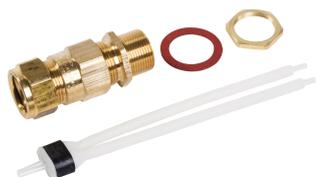
Les modèles nVent RAYCHEM C25-100-METAL et C3/4-100-METAL sont des kits de raccordement métalliques installés à froid, pour raccorder tous les câbles de chauffage parallèles industriels autorégulants à limitation de puissance nVent RAYCHEM à une boîte d'accouplement en métal ou en plastique avec plaque de mise à la terre interne. C25-100-METAL pour les entrées M25, C3/4-100-METAL : pour les entrées 3/4 po NPT.
