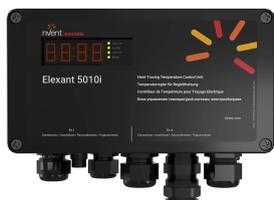
nVent RAYCHEM Elexant 5010i est un système perfectionné de contrôle électronique de la température monté sur site, offrant des fonctions de régulation locale et de surveillance centrale, utilisé pour les circuits monophasés jusqu'à 25 A et adapté aux zones à risque d'explosion. Le Elexant 5010i-LIM est équipé d'un limiteur électronique de température intelligent intégré (dispositif SIL 2).
