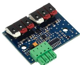
Le module enfichable nVent RAYCHEM Elexant 450c est un module de sonde qui permet de remplacer les anciennes commandes sans dénuder l'isolation et sans remplacer les sondes.
