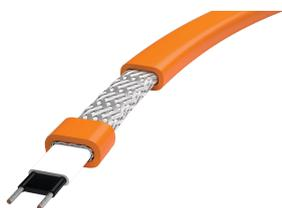
Le modèle nVent RAYCHEM ElectroMelt EM2-XR est un câble chauffant autorégulant robuste et solide utilisé pour empêcher la formation de neige et de glace sur les rampes, les baies de chargement, les escaliers extérieurs et les voies d'accès. La sortie de puissance est de 90 W/m à 0 °C.
