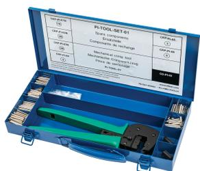
Le modèle nVent RAYCHEM PI-TOOL-SET-01 est une boîte à outils métallique contenant une pince à sertir mécanique, des matrices et des cosses à sertir nécessaires au raccordement des sorties froides et des câbles chauffants PI en combinaison avec le kit de raccordement/jonction de type CS-150-2.5-PI (coupe transversale jusqu'à 2,5 mm<sup>2</sup>).
