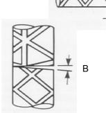
N.B. Ajustement ou rotation des extrémités des barres peut être necessaire pour obtenir un écart égalea, ou moins que é écartmaximum. La déviation maximum existe sur les deux extrémitésdes barres.
