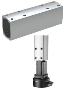
Les tubes Syspend 281-Max assurent l'intégrité de la structure et agissent comme conduit pour le câblage de l'équipement. Les tubes sont fixés aux composants du système avec 6 vis réglables à chaque extrémité du tube. Elles permettent un réglage et un nivellement simple du système. Ces vis sont fournies avec un enduit d'étanchéité de filetage offrant des raccordements assurés.
