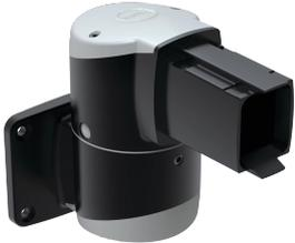
Le joint mural horizontal Syspend 281-Max permet de monter le système de suspension sur une surface verticale, ce qui permet au tube de s'étendre horizontalement. Le bras peut pivoter à 300 degrés. Comprend un arrêt de sécurité et des paliers sans entretien.
