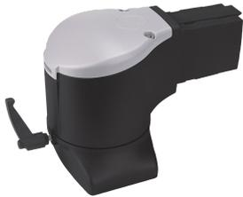
Le raccord à bride coudé Syspend 180-Max se fixe directement à l'armoire dans les applications où un tube vertical n'est pas nécessaire. Il permet à l'armoire de pivoter à 300 degrés et peut être verrouillé dans une position donnée. Le raccord à bride coudé a un arrêt de sécurité et des paliers sans entretien.
