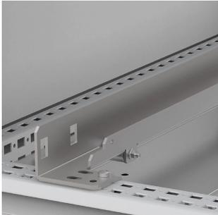
La roue réduit le frottement entre le profilé coulissant, le MTS et les plaques de montage, MPW/MP, réduisant la force à appliquer lors du montage latéral, spécialement conçue pour les configurations à forte charge.
