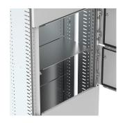
Cette plaque de séparation en acier zingué, MSESM, est disponible prête à l'emploi et prédimensionnée. La plaque doit être utilisée lorsque des sous-divisions doivent être séparées. Elle est placée entre une plaque de montage et l'embrasure de la porte pour les portes partielles. Aucune vis n'est nécessaire, ce qui facilite le montage. La section fixe peut alors être conforme à la forme 4 de la ségrégation selon la norme IEC 61439.
