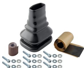
Le passe conducteur IP55 nVent ERIFLEX Flexbus peut être utilisé sur le dessus de l'armoire distribution et/ou de l'alimentation électrique (capot BT d'un transformateur par exemple) afin de faire passer l'étanchéité au niveau IP55. Il protège l'isolation du conducteur du Flexbus contre les arêtes vives au niveau des découpes de tôles.
