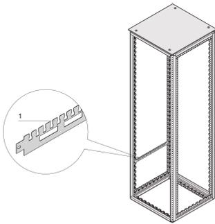
Traverse porte-câbles horizontale Varistar dans la profondeur de la baie. Fixation sur le cadre.
