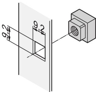
Les écrous carrés ont une surface de contact plus élevée et ne sont pas arrondis, contrairement aux écrous hexagonaux. Pour un montage sécurisé et anti-torsion précis sans jeu, utilisez des écrous carrés.
