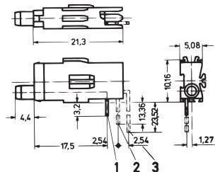
Douille de test pour niveau de montage 1 et 2, de type court et long.
