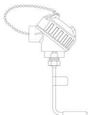
La sonde nVent RAYCHEM RTD-7AL est une sonde de température à résistance (RTD) en platine trois fils, qui s'emploie généralement avec les systèmes de régulation et surveillance nécessitant la précision de la régulation de température. Utilisé dans les emplacements CID1.
