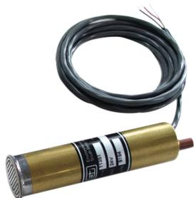
La sonde de neige nVent RAYCHEM détecte avec précision la chute ou les tempêtes de neige à des températures inférieures à 3,3 °C/38 °F pour les applications de déneigement de surface. La sonde aérienne pour système de déneigement CIT-1 est couplée soit à la sonde GIT-1 pour les applications de déneigement de chéneaux, soit à la sonde SIT-6E pour le déneigement de la chaussée.
