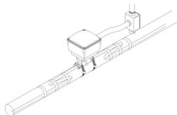
Le modèle nVent RAYCHEM AMG-BC-III est un kit de raccordement électrique NEMA 4X en aluminium sans cuivre pour une entrée de câble chauffant simple ou double. Les câbles chauffants peuvent être alimentés par un ou deux circuits. Le kit contient des matériaux pour une connexion électrique.
