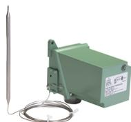
Le modèle nVent RAYCHEM AMC-2B-2 est un thermostat de sondage de ligne conçu pour réguler les systèmes de traçage électrique dans les zones non dangereuses. Il détecte les températures des parois des conduits ou des réservoirs et est utilisé pour réguler directement un circuit de traçage électrique, fonctionnant en tant qu'interrupteur bipolaire unidirectionnel (DPST), ouvrant et fermant la connexion électrique aux deux fils de bus du câble chauffant.
