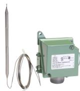
Le modèle nVent RAYCHEM AMC-1B est un thermostat de sondage de ligne conçu pour réguler les systèmes de traçage électrique dans les zones explosibles. Il détecte les températures de la tuyauterie ou de la paroi du réservoir, utilisé pour contrôler un circuit de traçage électrique unique ou commuter plusieurs circuits avec un contacteur, il dispose d'un point de consigne réglable. Également utilisé pour indiquer des conditions d'alarme de température basse ou élevée.
