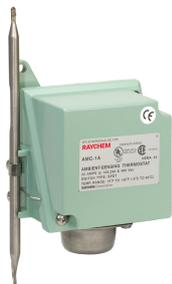
Le modèle nVent RAYCHEM AMC-1A est un thermostat mécanique de température ambiante conçu pour réguler les systèmes de traçage électrique utilisés pour la mise hors gel des emplacements non explosibles. Utilisé pour réguler un circuit de traçage électrique unique ou commuter plusieurs circuits par le biais d'un contacteur. Il dispose d'un point de consigne réglable.
